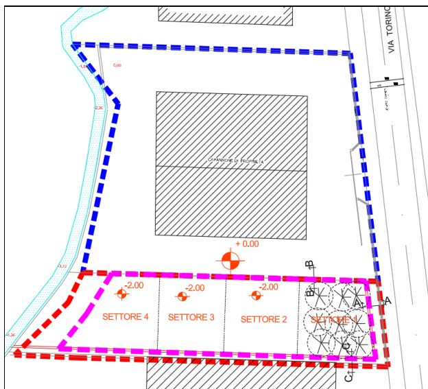
Sottofase 3 Completamento delle operazioni di frantumazione e caratterizzazione abbancamento del materiale trattato nel settore i-esimo
