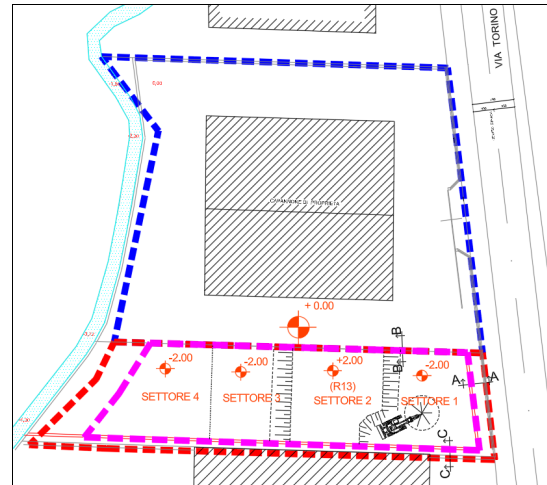
Sottofase 2 Frantumazione dei rifiuti ed abbancamento nel SETTORE 1
